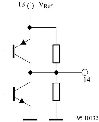
Figure 17. Pin 14 FM<sub>out</sub>
