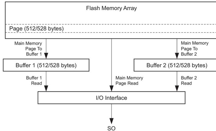
**Figure 25-1. Block Diagram**
